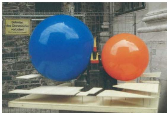
Fig. 5.1.1.6: Catedral de Aquisgrán (Aachen): Modelo con entorno y "esferas de rayo" para los niveles de protección II y III.
